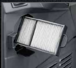
Filtre d'aspiration d'air extérieur
